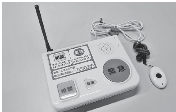
取り付ける緊急通報装置
