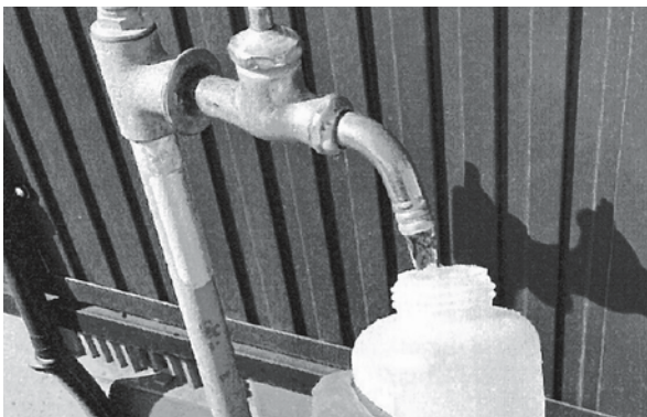
水質検査の採水の様子
