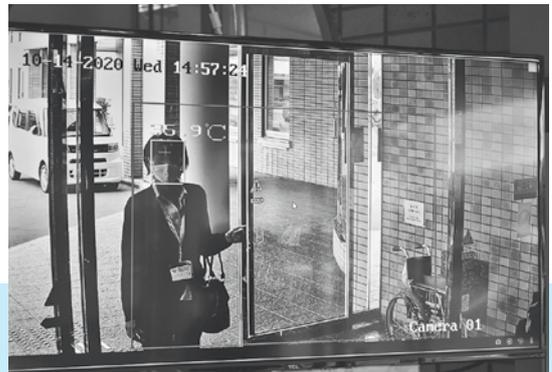
市役所のサーマルカメラ撮影映像。瞬時に顔を判別し体温を計測します。
