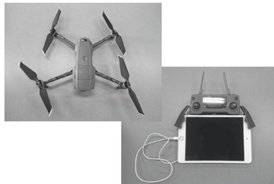
本市所有のドローン一式（左がドローン本体。右がコントローラーとタブレット）。タブレットで映像を確認しながら操作可能。
