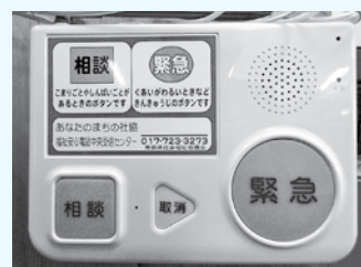
緊急通報装置
