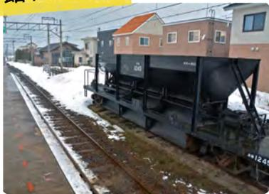
旧国鉄時代の1964年（昭和39年）に製造されたホキ800形貨車。碎石を散布する車両です。
