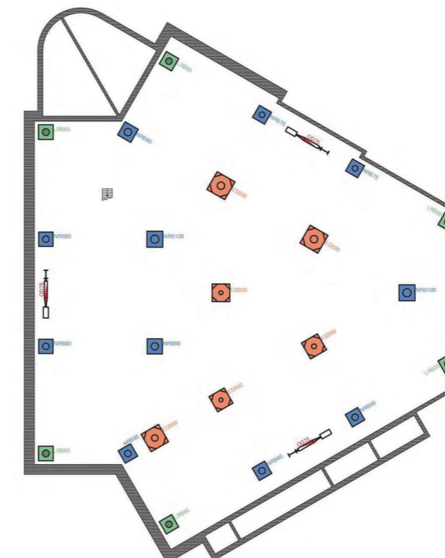
免震層における免震装置の配置
